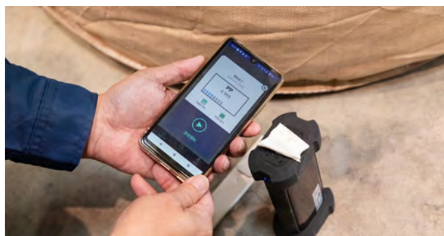
製品プラの品質確認にRICOHハンディセンサーを活用。高純度の再生プラスチック生産を支える。
