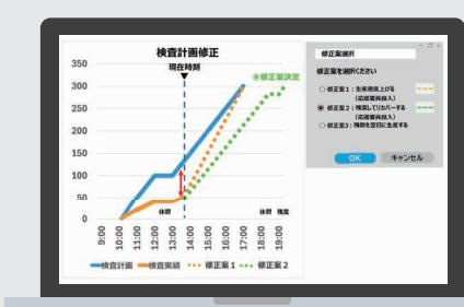
修正計画選択画面で検査工程の遅れを回復するための修正案を選択し、変更内容を各工程のモニタに表示・共有。関連部署に修正計画や人員確保の連絡が可能に。
