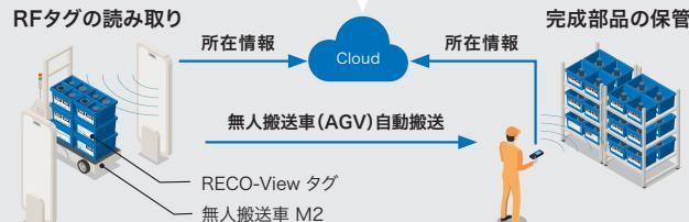
RECO-View タグを読み取ると、所在をリアルタイムに表示・共有。また指定された工程や保管場所にAGVが自動搬送する。
