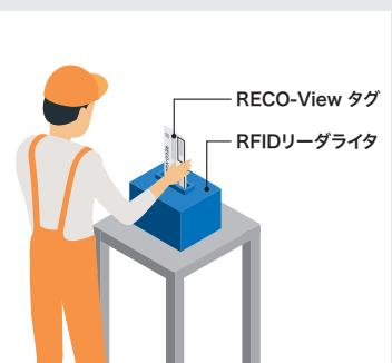
RECO-View タグをRFIDリーダライタに差すと、作業開始が記録される。タグを抜くと作業完了の情報が遠隔地にも共有されます。
