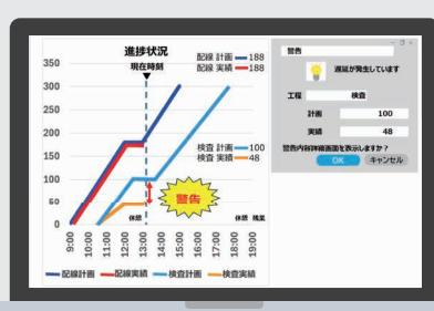
工程別進捗確認モニタで検査工程の遅延をリアルタイムに表示・共有。遅延が発生した際は、警告内容詳細画面から遅延の詳細情報と原因を確認可能。
